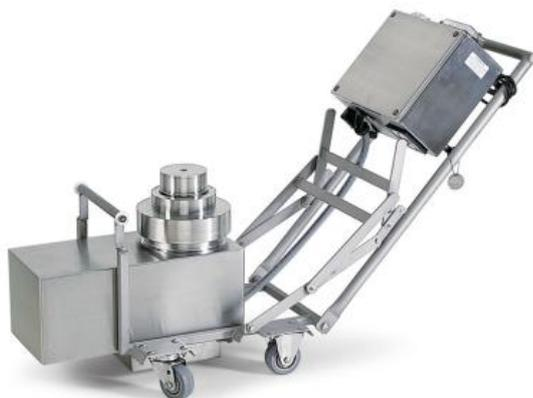
Мобильный привод LevMixer® обеспечивает левитирование и вращение одноразового магнитного импеллера без каких-либо креплений, передаточных механизмов или поверхностного контакта. Это позволяет системе Flexel® 3D LevMix эффективно перемешивать порошки, суспензии, растворы или эмульсии. Привод установлен на тележке и сконструирован так, чтобы обеспечивать взаимодействие с контейнерами различных объемов.
