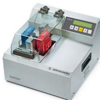
BioWelder® — автоматический прибор для стерильного соединения термосвариваемых трубок. Принцип работы прибора заключается в том, что два конца трубок вставляются в держатели, затем они срезаются лезвием и сплавляются вместе. Лезвие находится в стерильных условиях в течение процесса. Таким образом, стерильное соединение трубок можно провести и в нестерильных условиях.
