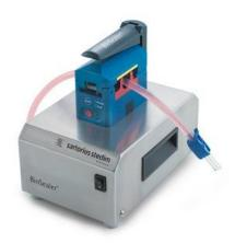
BioSealer® — полностью автоматизированный прибор, созданный для постоянного, стойкого, без протечек запаивания термопластичных трубок. Принцип работы: пустая или наполненная жидкостью трубка вставляется в прибор и запаивается с помощью нагретых керамических пластин. Жидкость из внутренней части трубки удаляется и трубка запаивается до однородного состояния. В случае необходимости запаянный участок можно срезать острыми ножницами.
