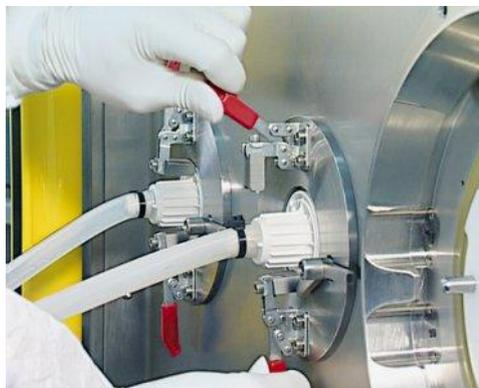
Система быстрой асептической передачи жидкости SART System™ разработана для транспортировки жидкостей между двумя помещениями с различными классами чистоты в асептических условиях. Система SART System™ состоит из внешнего и внутреннего портов и одноразового устройство подсоединения Gammasart ATD™.
