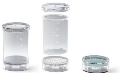
Одноразовые мониторинговые системы Biosart® 100 предназначены для осуществления микробиологического анализа различного рода жидкостей методом мембранной фильтрации. Biosart® 100 является закрытой системой, состоящей из основания фильтродержателя с мембранным фильтром и адсорбирующей подложки для питательной среды, градуированной воронки и крышки.
