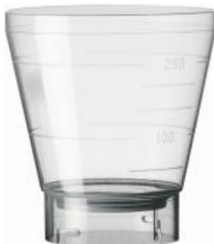
Воронка Biosart® 250 используется для микробиологического контроля качества фармацевтических и косметических препаратов, воды и напитков. Коническая форма воронки обеспечивает качественную промывку системы после фильтрации. Конструкция фильтродержателя и одноразовой воронки Biosart® 250 позволяет значительно упростить анализ и повысить достоверность результатов, а их соединение байонетного типа позволит сократить риск контаминации.
