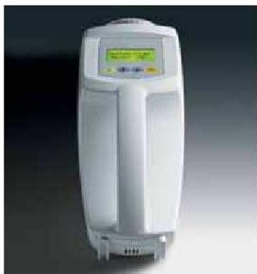
AirPort MD8 – это новый пробоотборник воздуха для фармацевтических производств, биотехнологии, производств пищевых продуктов и напитков, для больниц, и для проведения измерений в рамках защиты окружающей среды и производственной техники безопасности.
