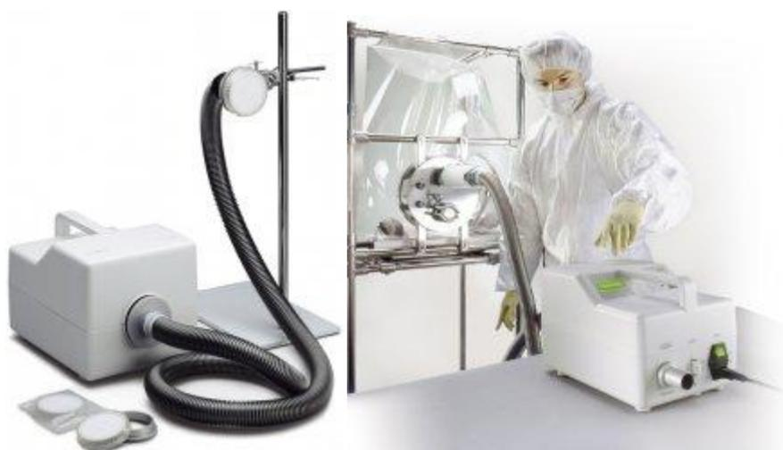
Система MD8 airscan состоит из пробоотборника и одноразовых желатиновых мембранных фильтров. Система применяется для количественного обнаружения находящихся в воздухе микроорганизмов. Преимущественно, используется в стерильных зонах класса А и В (по классификации в соответствии с GMP), в изоляторах, системах Blow Fill Seal.
