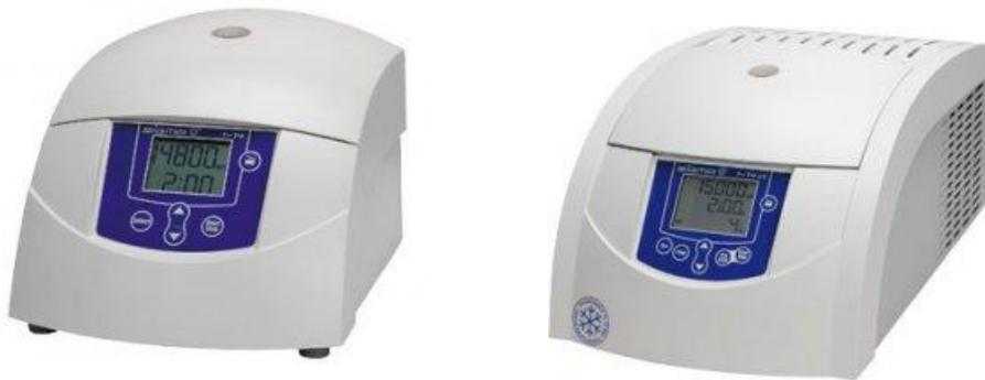
Высокоскоростные лабораторные микроцентрифуги для центрифугирования в микропробирках объемом 0,2 – 2,0 мл без охлаждения камеры ротора или с функцией охлаждения.
