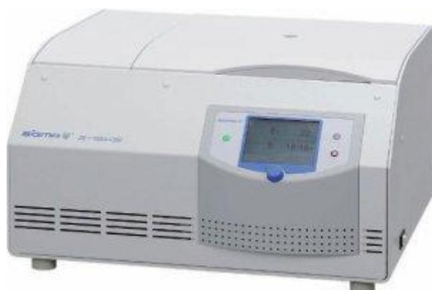
Центрифуги 3-18KS / 3-18KHS – универсальные лабораторные высокоскоростные центрифуги для разделения фаз в объемах до 400 мл и использования угловых и бакет-роторов с функциями охлаждения и / или нагревания.
