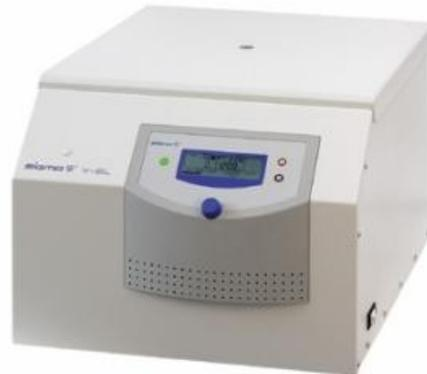
Центрифуга SIGMA 4-5L – центрифуга большой вместимости. Основные свойства центрифуги включают новый привод с высоким крутящим моментом для быстрого ускорения и оптимизированную циркуляцию воздуха в камере ротора для более эффективного охлаждения ротора и обеспечения низкого уровня шума.
