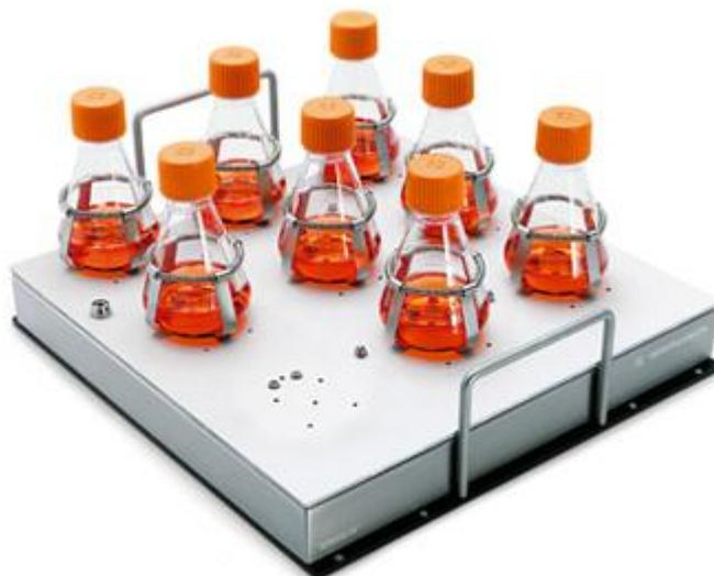
**SENSOLUX®** - функционально-законченная, автономная версия платформы для шейкера, оснащенная оптической системой датчиков для контроля pH и DO в процессе культивирования животных клеток в колбах Эрленмейера. Платформа для шейкера SENSOLUX® используется в сочетании с одноразовой колбой Эрленмейера - SENSOLUX® EF.
