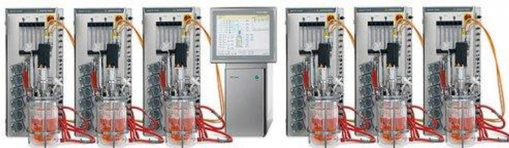
**Многоцелевая система BIOSTAT® B DCU II** — биореактор, предназначенный для сферы научно-исследовательских разработок, а также для усовершенствования технологического процесса. BIOSTAT® B DCU II даёт возможность проведения прямого и обратного масштабирования различных ферментационных процессов и обеспечивает новый уровень эффективности и универсальности.
