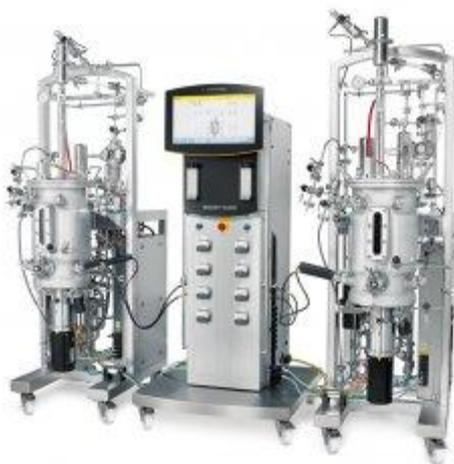
**BIOSTAT® D DCU** — новый стерилизуемый на месте биореактор для работы с культурами клеток и микроорганизмами с рабочим объемом 10, 20, 30, 50, 100 и 200 л. BIOSTAT® D DCU разработан с учетом самых современных технологий и направлений дизайна и позволяет создание как классических, так и гибридных систем.
