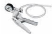
Материал корпуса - поливинилхлорид; соединительный шланг из прозрачного пластика длиной 60 см. Насос может использоваться в полевых условиях. Обеспечивает до 80 % вакуума (165 мм рт. ст.)
