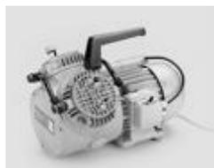
Напорный насос обеспечивает безмасляное нагнетание воздуха до 7 бар. Наружная резьба G 3/8 на выходе давления; ниппель 9 мм на линии входа воздуха в насос. Оба разъёма являются взаимозаменяемыми и имеют резьбу G 1/4.
