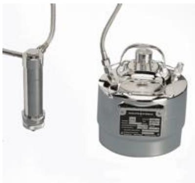
Напорные емкости изготовлены из высококачественной стали марки 1,4401 (AISI 316) с уплотнениями из силикона. Напорные танки имеют две ручки и крышку с манометром, аварийный клапан и винтовое уплотнение. Труба передавливания расположена таким образом, чтобы обеспечить полное опорожнение емкости.
