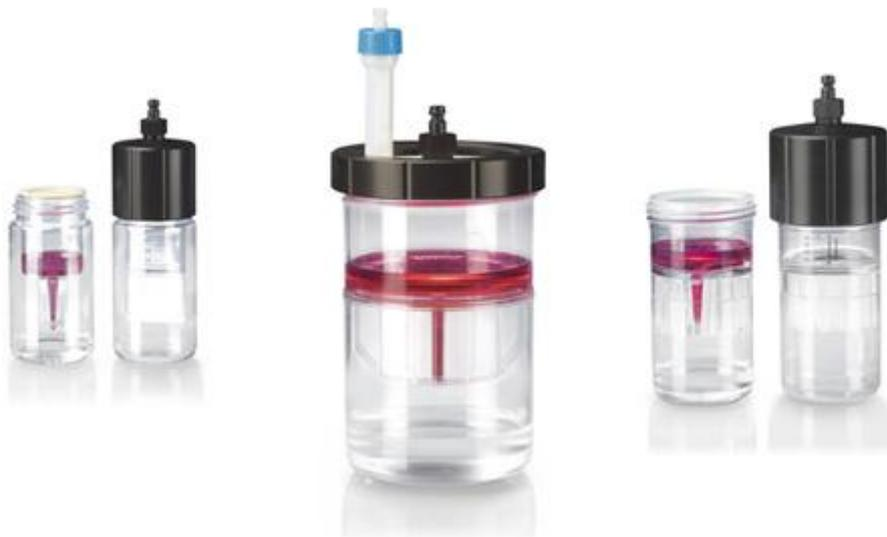
Предназначены для концентрирования растворов высокомолекулярных соединений объемом от 10 до 250 мл. Хорошо подходят для работы с вязкими продуктами или для работы при пониженных температурах. Концентраторы можно использовать в сочетании с центрифугой, шейкером или источником давления.
