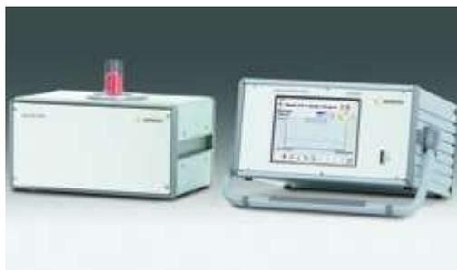
Семейство измерителей влаги LMA320PA разработано для быстрого анализа влажности и плотности в лаборатории или рядом с производственной линией. Благодаря своей модульной конструкции эти измерители влаги могут подключаться к различным типам датчиков, в зависимости от свойств пробы и диапазона содержания влаги. Процедура измерения позволяет производить анализ, независимый от плотности, обеспечивая при этом предельно простую автокалибровку для поддержания долгосрочной стабильности.
