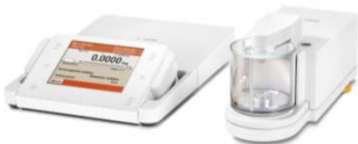
Классы точности проверяемых гирь: E1, E2, F1, F2, M1: 1 мг – 5 г
