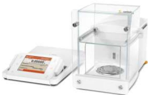
Классы точности проверяемых гирь: E1: 50 мг – 20 г E2, F1, F2, M1: 1 мг – 20 г
