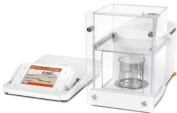
Классы точности проверяемых гирь: E1: 200 г – 500 г E2: 10 г – 500 г F1: 200 мг – 500 г F2: 5 мг – 500 г M1: 1 мг – 500 г
