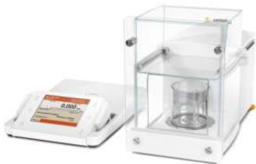
Классы точности проверяемых гирь: E1: 200 г – 1 кг E2: 50 г – 1 кг F1: 1 г – 1 кг F2: 20 мг – 1 кг M1: 1 мг – 1 кг
