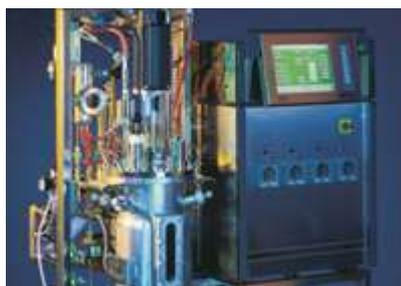
**Biostat C-DCU** — компактный лабораторный ферментер, стерилизуемый на месте, с рабочими объемом до 30 л, создан для микробиологических исследований и культур клеток. Ферментер обладает большим количеством функций, высокоэффективной системой датчиков. Управление ферментером осуществляется через дисплей с сенсорным управлением.
