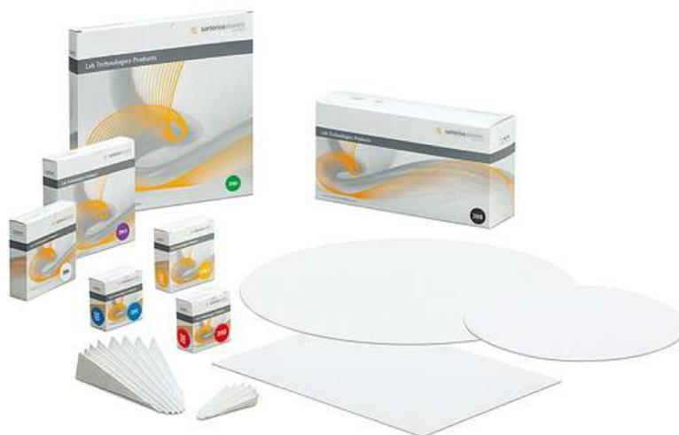
Данные виды бумаги используются для количественного и гравиметрического анализа, а также для напорной и вакуумной фильтрации. Они изготовлены из 100% хлопкового волокна с содержанием  $\alpha$ -целлюлозы > 98%, обеззолены кислотой и имеют высокую степень чистоты. Данная фильтровальная бумага имеет особо низкую зольность не более 0,01% в соответствии с DIN 54370.
