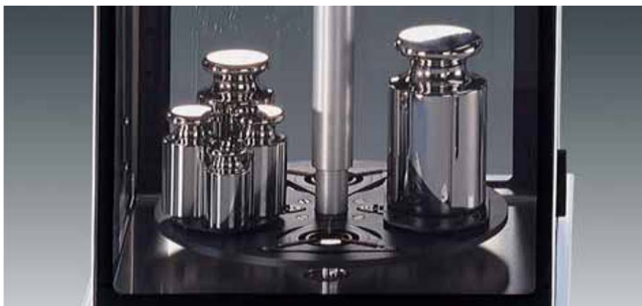
Сравнение эталонов массы как групп гирь при помощи CC1000S-L
