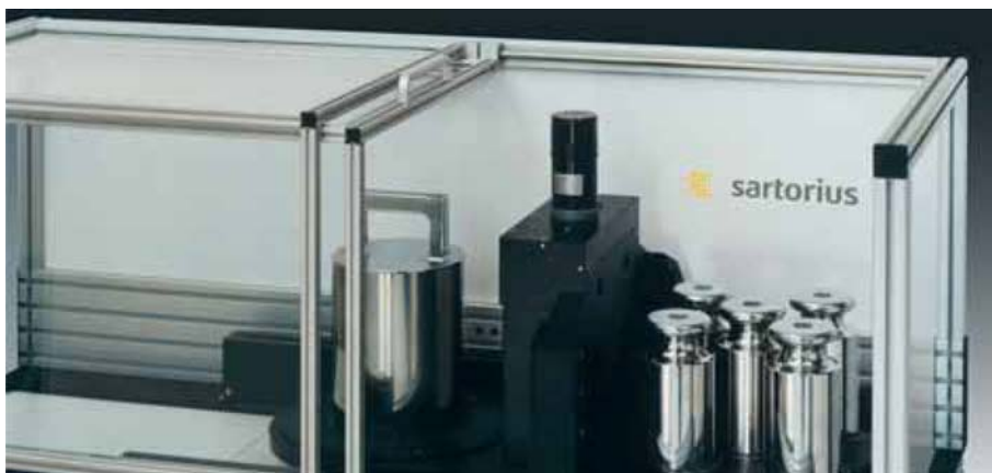
Сравнение гири с группой эталонов массы при помощи CC50001S-L
