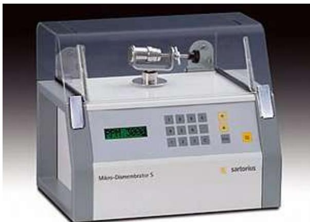
**Mikro-Dismembrator U** – шаровая мельница для твердых и замороженных образцов: семена растений, пигменты, волосы, ногти, кости, хрящи, замороженные ткани и клетки, минералы.
