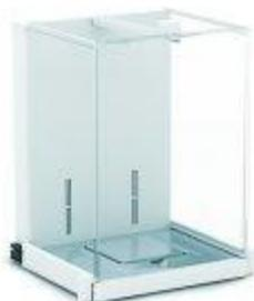
**DA** – Автоматическая ветрозащитная витрина (MSA, MSU)
