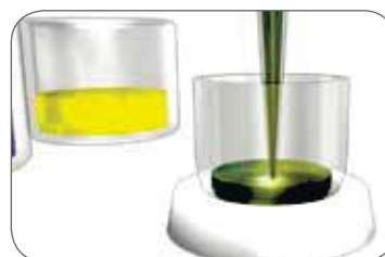
Рекомендуется предварительно промывать наконечник в случае, если температура жидкости не отличается от температуры окружающей среды
