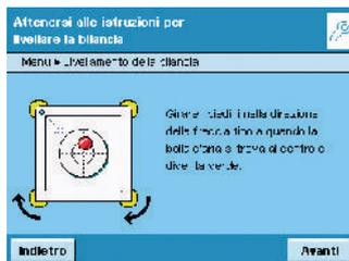
Технология Q-Level сочетает в себе оригинальные датчики с самым совершенным устройством отображения информации: это облегчает и ускоряет выставление весов по уровню. Функция ручного выравнивания с интерактивными подсказками входит в базовую комплектацию блоков индикации и управления MSA и MSU. При этом на дисплее отображается вся необходимая вам информация: положение воздушного пузырька и указание, какую установочную ножку и в каком направлении необходимо вращать (в MSE: только символы).
