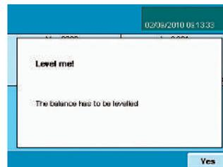
Весы Cubis® оснащены функциями предупреждения и напоминания с возможностью внесения в память последовательности операций для выравнивания, установки минимального веса образца и калибровки/юстировки.
