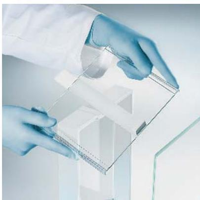
При очистке все панели ветрозащитной витрины можно снять всего за несколько этапов, не нарушив при этом устойчивости всей конструкции.
